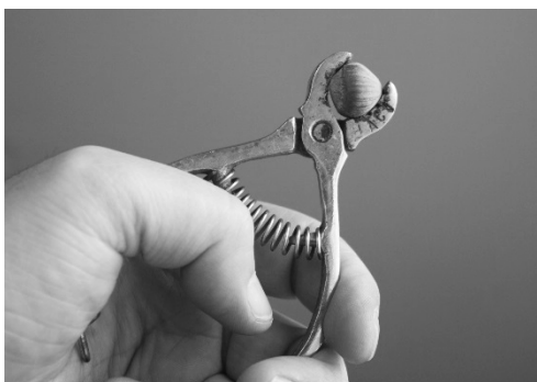
Le casse-noix réduit l'ampleur de l'effort nécessaire (la force à fournir) pour la charge (casser la coquille).
